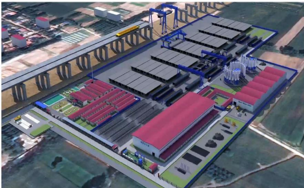
Princip fabrik för prefabricering bro element, ca 12 hektar, (CRIG)
