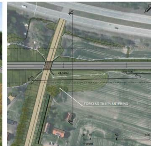
Figur 4.113 Illustrationsplan – Bullerskyddsvall vid Hillestalund. Stängselplacering enligt järnvägsplan. För detaljerad landskapsanpassning föreslås att stängslet placeras längre ner i slänten, se Figur 4.110.
