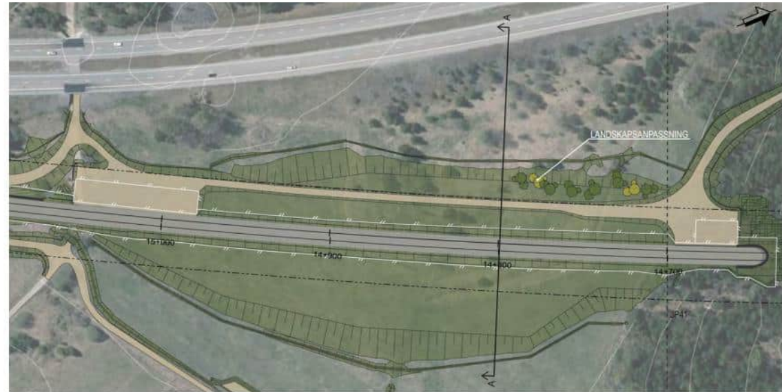
Figur 4.8 Illustrationsplan över tryckbank vid Lindefältet.
