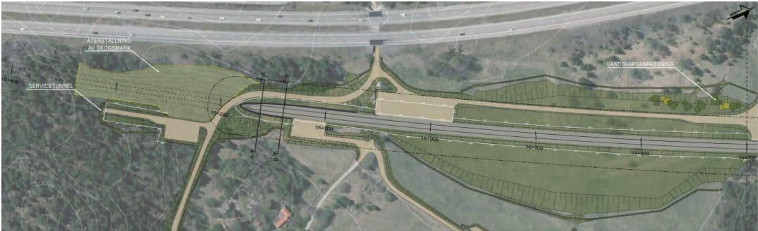
Figur 4.10 Illustrationsplan – Tunnelmynning norr om Tullgarnstunneln.
